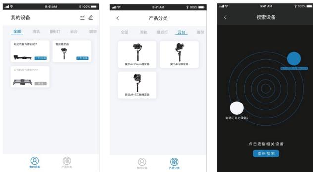
热狗三代电控模块通电并短按【电源开关按键】开机，打开手机蓝牙和GPS位置信息，打开 YC Onion 应用程序，在主页面“产品分类”-“滑轨”中，选择相对应设备的型号进行搜索，点中搜索到的设备即可连接。
