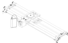
使用常规的移动电源, 通过 5.5×2.1mm DC 电源线 (标配), 即可为 热狗三代电控模块普通版 供电。
